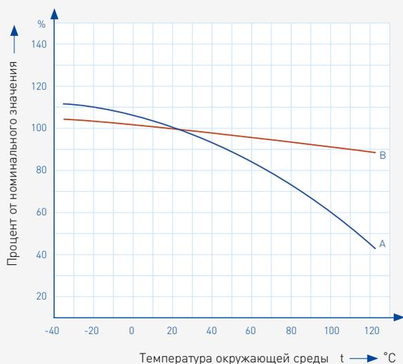
Зависимость отключающей способности от температуры окружающей среды
