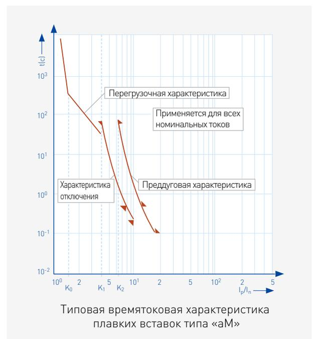
Типовая времятоковая характеристика плавких вставок типа «аМ»
