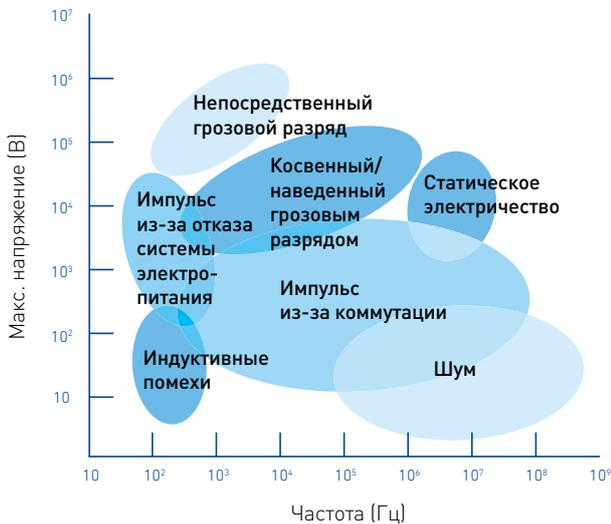
Рис. 1 Различные источники импульсов перенапряжения
