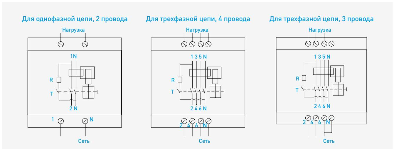
Линейку 4-полюсных ВДТ от Hyundai можно использовать для обеспечения защиты от тока утечки в 3 фазах. В 3-проводных цепях (без нейтрального проводника) необходимо поставить перемычку между одной фазой и нейтралью на входе ВДТ, чтобы обеспечить работу ВДТ.
