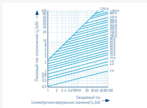
Характеристические кривые тока отключения плавких вставок gG
