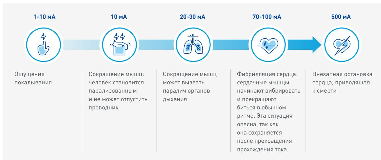
Однако поражение электрическим током нельзя рассматривать только в терминах величины тока, нужно учитывать еще «контактную разность потенциалов». Человек получает поражение электрическим током, если он касается объекта, электрический потенциал которого отличается от потенциала человека. Разность потенциалов приводит к протеканию тока через организм человека.
