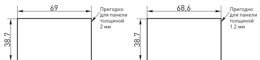
Установка DU06 с фиксацией с защелкиванием Установка винтов: чертеж с размерами прорези в панели
