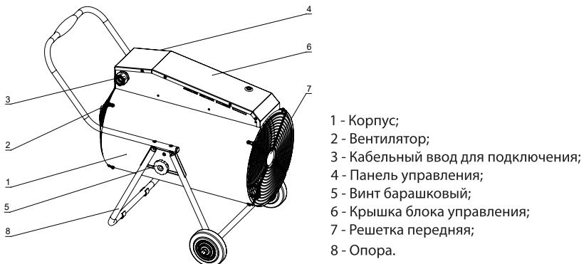
Рис. 1.1 Устройство прибора. Модели ТР-21380S, ТР-27380S
