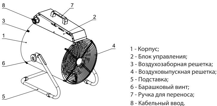
Рис. 1.2 Устройство прибора. Модель ТР-15380S
